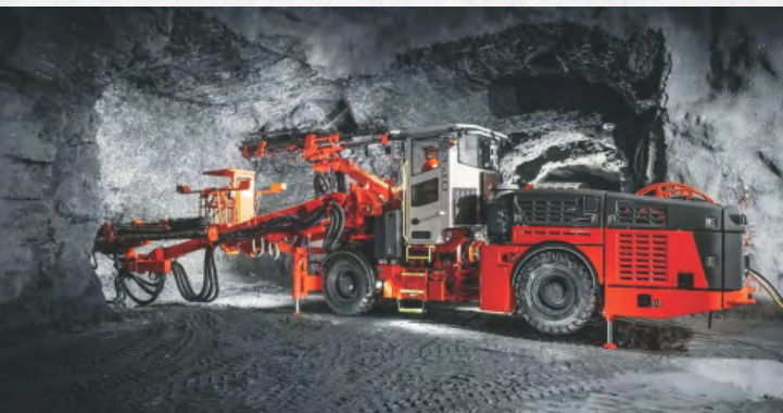
Los equipos Jumbos son usados para las operaciones de perforación de tuneles horizontales y pueden ser de 1 hasta 3 brazos
