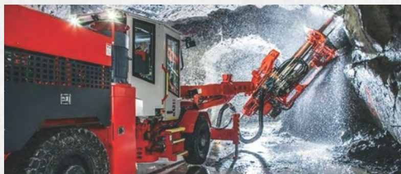
Los equipos Simba o Jumbos de producción son usados para las operaciones de perforación en mineral, tienen la peculiaridad de perforar en abanico y alcanzar distancias de perforación de mas de 30 mts, son usados para cuerpos de grandes dimensiones.
